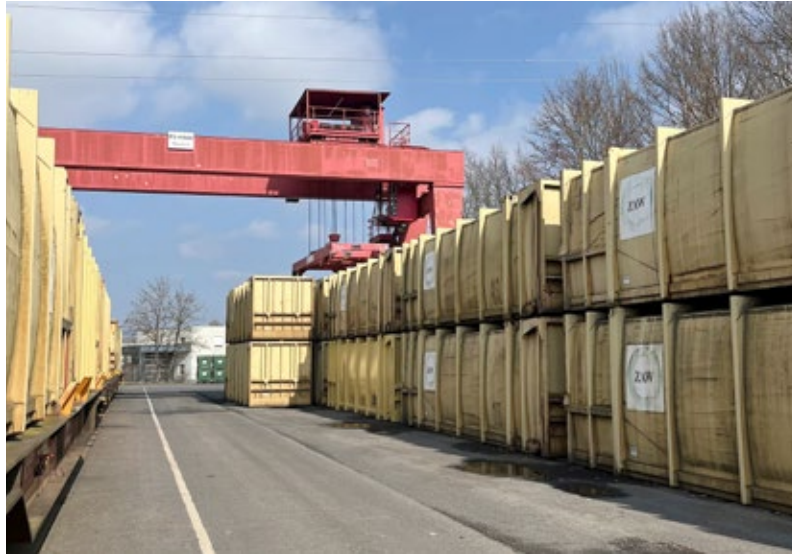
Containerbahnhof in Coburg am MHKW. Hier werden die Spezialcontainer entladen und der Müll im MHKW thermisch verwertet.
